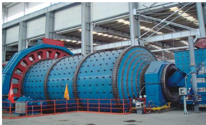
1.8 Сурет – Шар диірмені Ø 6,2×9,5 м, 2 дана, 6000 кВт
