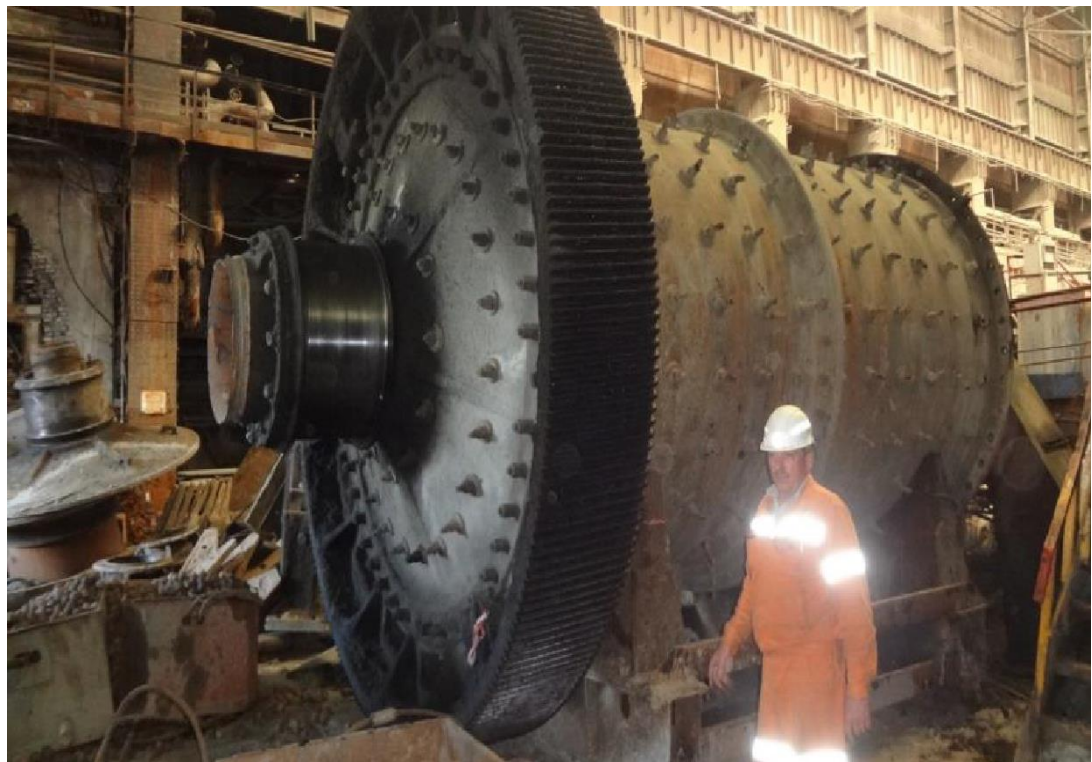
1.5 Сурет – Күрделі жөндеу кезіндегі шарлы диірмен
