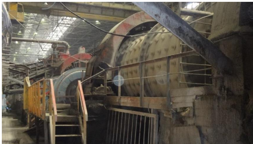
1.3 Сурет – БОФҚА шарлы диірмендермен ұнтақтау учаскесі
